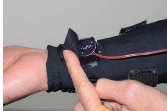
(d) Velcro slots to hold vibration motors
