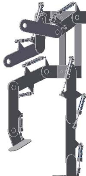
Рис.3б. Кинематическая схема экзоскелетона с использованием гидроцилиндров
