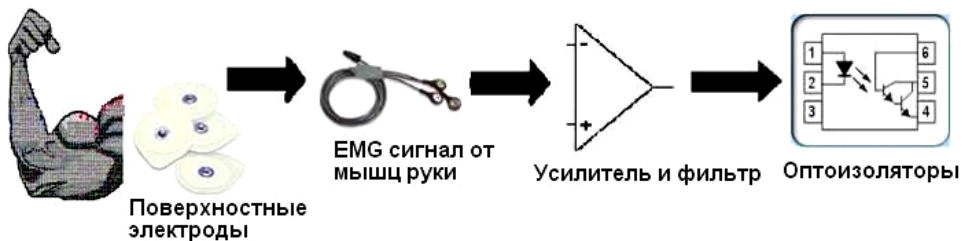
Рис.11. Схема прохождения сигнала от мышцы до управляющего элемента
