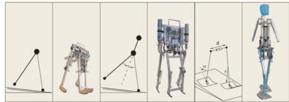
Figura 7: Modelos reducidos basados en el “Simplest Walker” usados para el diseño de MIKE, MAX y Denise. Adaptada de [38].
