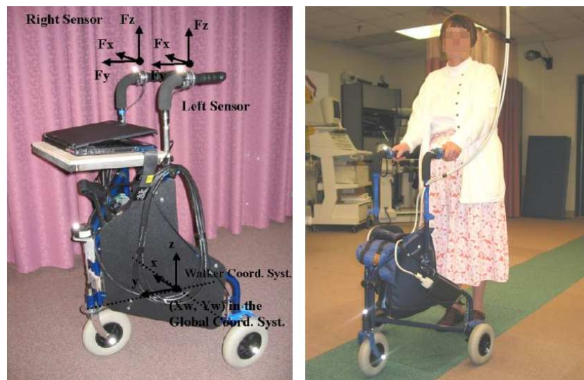
FIG. 2.6: Déambulateur instrumenté : assistance à la locomotion [Wasson et al. , 2004].
